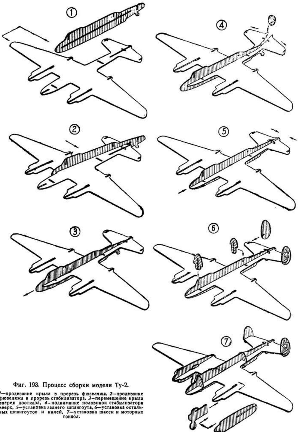
Фиг. 193. Процесс сборки модели Ту-2.
